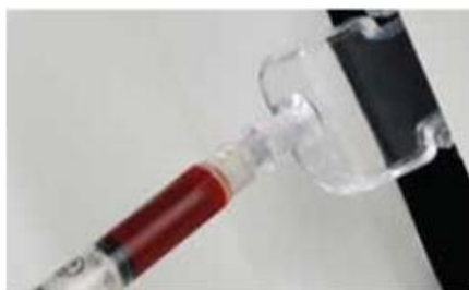
Las jeringas se pueden acoplar y tomar muestras sin usar las manos.
